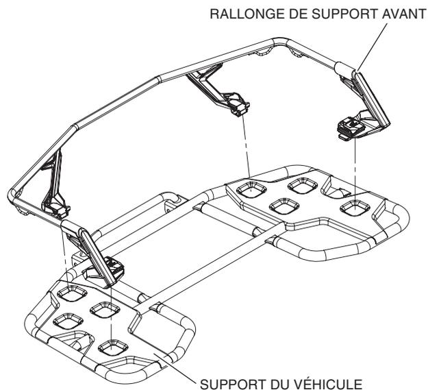
4. Fixez la rallonge de support avant au support du véhicule en abaissant le levier de chaque loquet Honda Pro-Connect<sup>MC</sup>.
