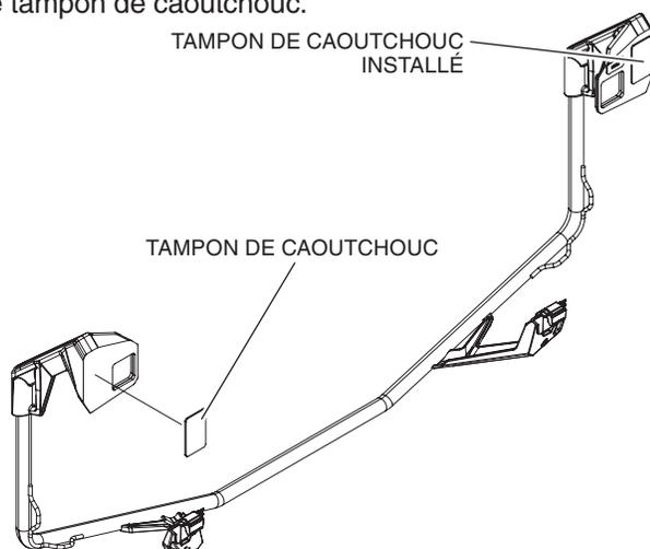
2. Installez deux loquets Honda Pro-Connect<sup>MC</sup> dans la rallonge de support avant en insérant une entretoise en caoutchouc entre chaque loquet et la rallonge de support avant. Fixez les loquets à la rallonge de support avant à l'aide d'un anneau élastique sur chaque loquet depuis le dessous de la rallonge de support avant.
