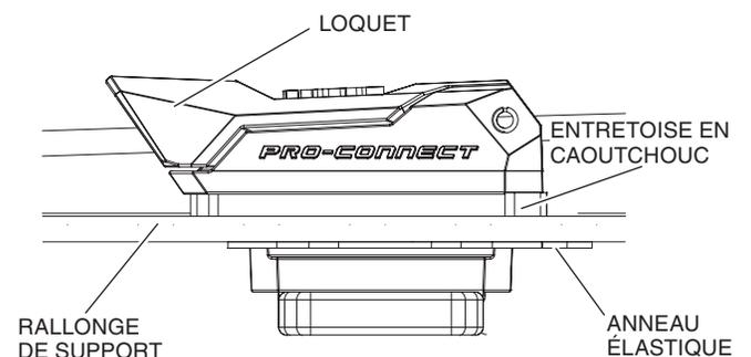
3. Soulevez le levier de chaque loquet jusqu'à ce qu'il se déverrouille. Placez la rallonge de support avant sur le support avant du VTT. Alignez chaque loquet avec chaque orifice correspondant dans le support, puis insérez chaque loquet dans son orifice.
